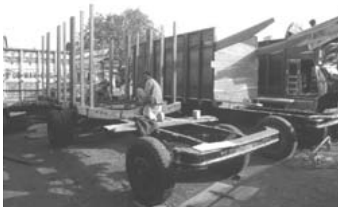
Foto 2: Das Chassis im Vordergrund ist bereits mit den Eisenverstreben und den Querbalken für den Aufbau ausgestattet. Die Ladefläche des daneben stehenden Trucks ist vollständig aufgebaut, beim dritten werden Arbeiten an der Fahrerkabine und dem Aufbau ausgeführt. Juni 1995. Foto: Sajid Munir.
